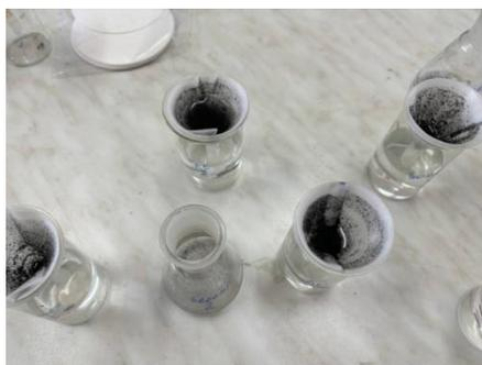
Рисунок 7 – фильтрование проб от частиц УНВ
