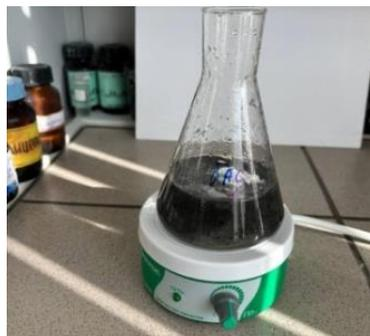
Рисунок 6 – УНВ в процессе адсорбции хлора
