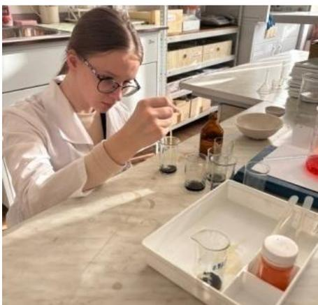
Рисунок 1 – процедура отмывки нановолокон соляной кислотой
