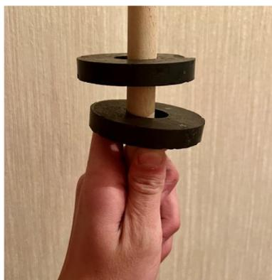
Рисунок 2 – однокоординатный левитатор
