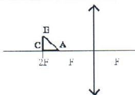
62. На экране с помощью тонкой линзы получено изображение стержня с пятикратным увеличением. Стержень расположен перпендикулярно главной оптической оси, и плоскость экрана также перпендикулярна этой оси. Экран передвинули на 30 см вдоль главной оптической оси линзы. Затем, при неизменном положении линзы, передвинули стержень так, чтобы изображение снова стало резким. В этом случае получено изображение с трехкратным увеличением. Определите фокусное расстояние линзы.
