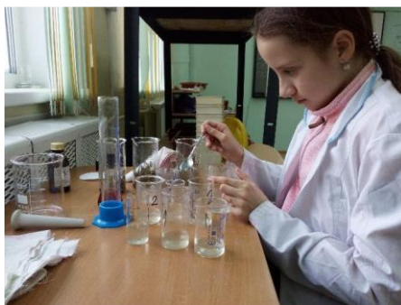
Фото 1. Определение содержания аскорбиновой кислоты методом йодометрии.
