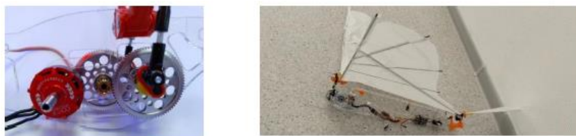
Рисунок 2. Модернизация редуктора и основания птицы
